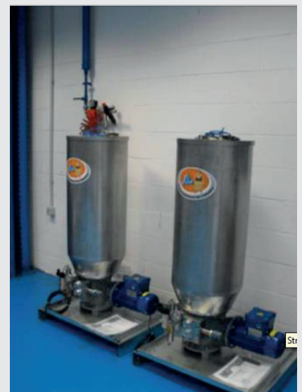
Pompa SUMO ATEX ze stali nierdzewnej 316 z silnikiem i zbiornikiem Ex d.
