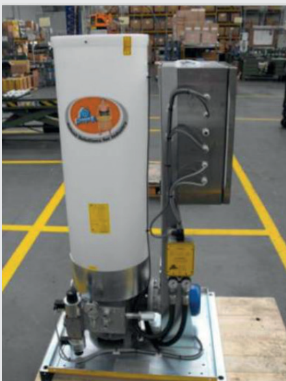
Pompa SUMO – półprzezroczysty zbiornik, z czujnikiem ciśnienia końca linii oraz sterownikiem w obudowie ze stali nierdzewnej.
